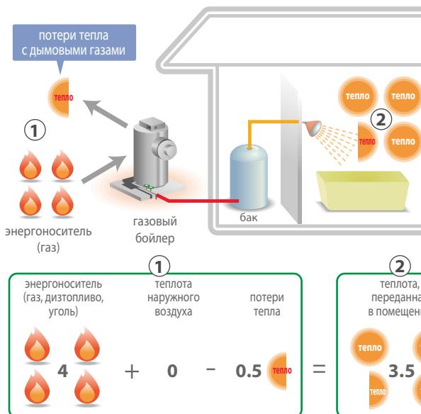
Принцип получения тепла с помощью теплового насоса отличается от традиционных систем нагрева, основанных на сжигании газа или жидкого топлива, а также прямого преобразования электрической энергии в тепловую. В таких системах единица энергии энергоносителя преобразуется в неполную единицу тепловой энергии. В то время как тепловой насос, затрачивая единицу
