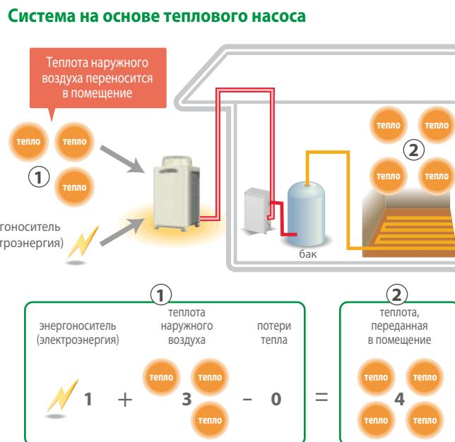
электрической энергии, «перекачивает» в помещение от 2 до 6 единиц тепловой энергии, забирая ее из наружного воздуха. Поэтому высокая эффективность воздушного теплового насоса делает естественным выбор в пользу таких систем для отопления помещений и нагрева воды на объектах, имеющих ограниченные энергоресурсы.
