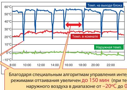
Пример эксплуатации наружного блока
