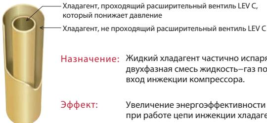
**Назначение:** Жидкий хладагент частично испаряется, и двухфазная смесь жидкость–газ подается на вход инжекции компрессора.
