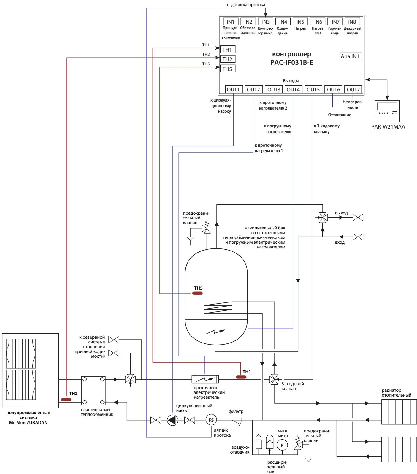
Данная схема является упрощенной и приведена в качестве примера. Для реальных проектов требуется более детальная проработка электрической схемы, а также схемы гидравлического контура.
