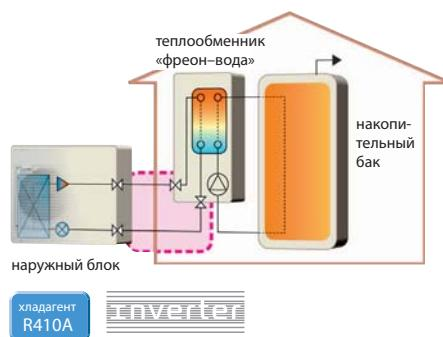
**Наружные блоки, допускающие подключение внешнего теплообменника**
