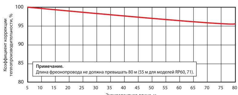
**(3) Выбор наружного агрегата, вычисление скорректированной теплопроизводительности**
