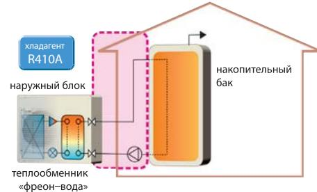
тепловые насосы для нагрева воды "воздух-вода"
