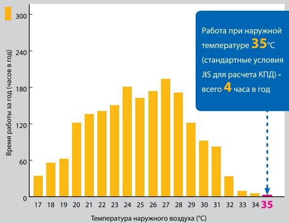
Работа при наружной температуре **35°C**
